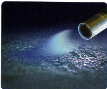
Рис. 64. Струя фтора, направленная на поверхность воды, вызывает появление голубого пламени
