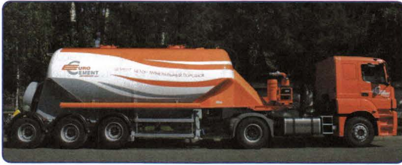
Рис. 29. Цементный раствор перевозят в специальных автомашинах
