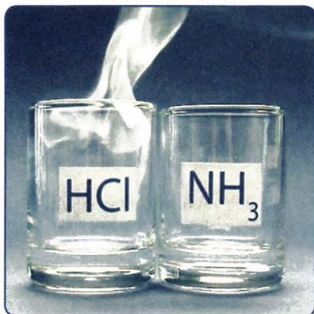
Рис. 66. Опыт «дым без огня». Пары хлороводорода и аммиака, взаимодействуя, образуют кристаллики хлорида аммония, похожие на дым
