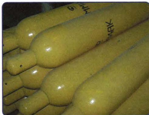
Рис. 88. Жидкий аммиак хранят и транспортируют в баллонах жёлтого цвета
