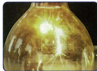
Рис. 73. Горение железа в кислороде
