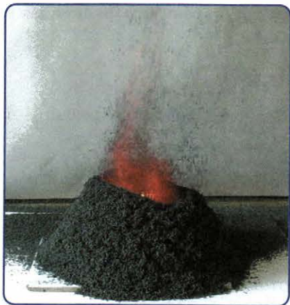
Рис. 89. Разложение дихромата аммония (химический вулкан)
