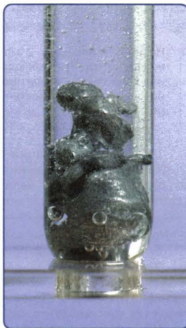
Рис. 6. Взаимодействие цинка с раствором соляной кислоты
