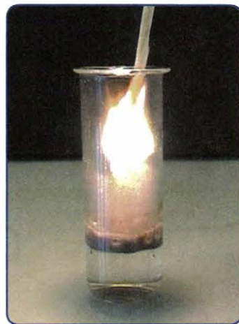
Рис. 71. Получение кислорода разложением пероксида водорода и обнаружение кислорода с помощью тлеющей лучинки
