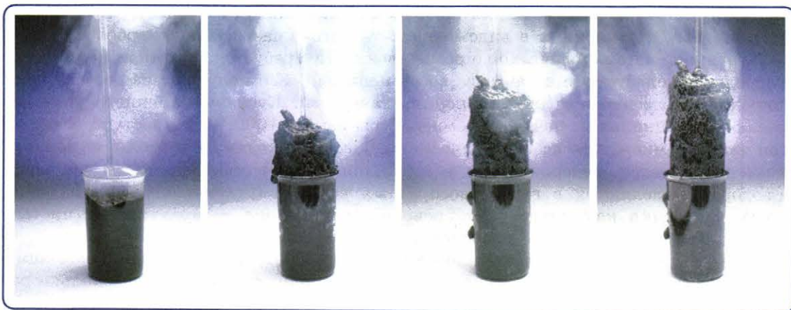
Рис. 97. Взаимодействие сахара с концентрированной серной кислотой
